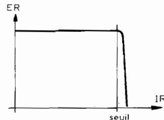
Fig. 13a - Système de limitation. Quand la tension aux bornes de R.limit atteint 0,6 à 0,8 V ( V_{be} de T2) T2 conduit entre émetteur et collecteur et relie plus ou moins la base de T1 à son émetteur, donc diminue le courant possible en sortie, si on dépasse celui-ci la tension de sortie s'effondre.
